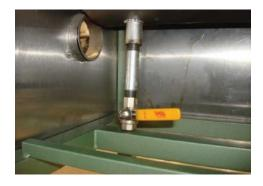
Colocar niple 1/2" x 4" y llave de desagüe 1/2" en parte inferior del freidor (no incluye el equipo).
